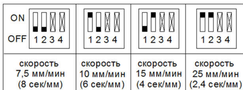
Рисунок 3. Комбинации положения переключателей SA1.1 и SA1.2 для настройки скорости перемещения штока
