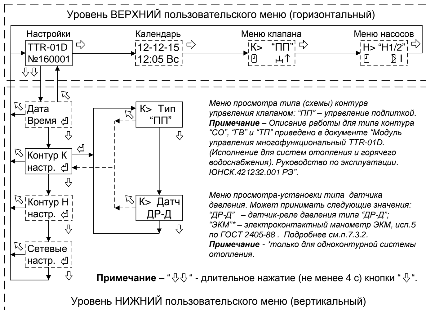
Рисунок 4 - Структура меню настройки параметров контура клапана подпитки
