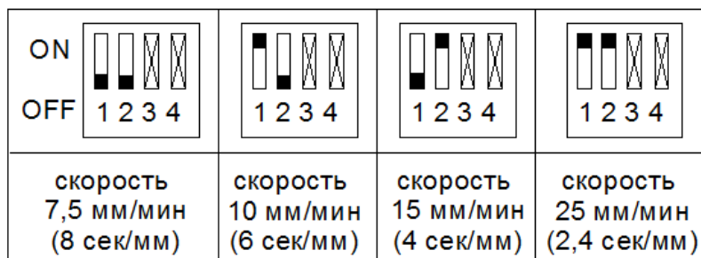
Рисунок 4. Комбинации положения переключателей SA1.1 и SA1.2 для настройки скорости перемещения штока
