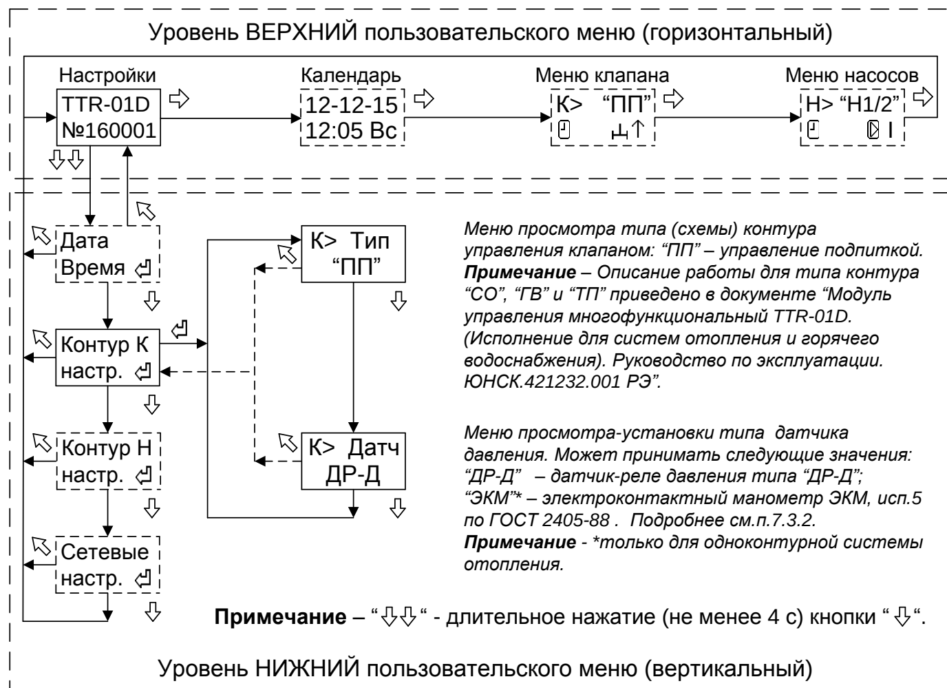
Рисунок 4 – Структура меню настройки параметров контура клапана подпитки
