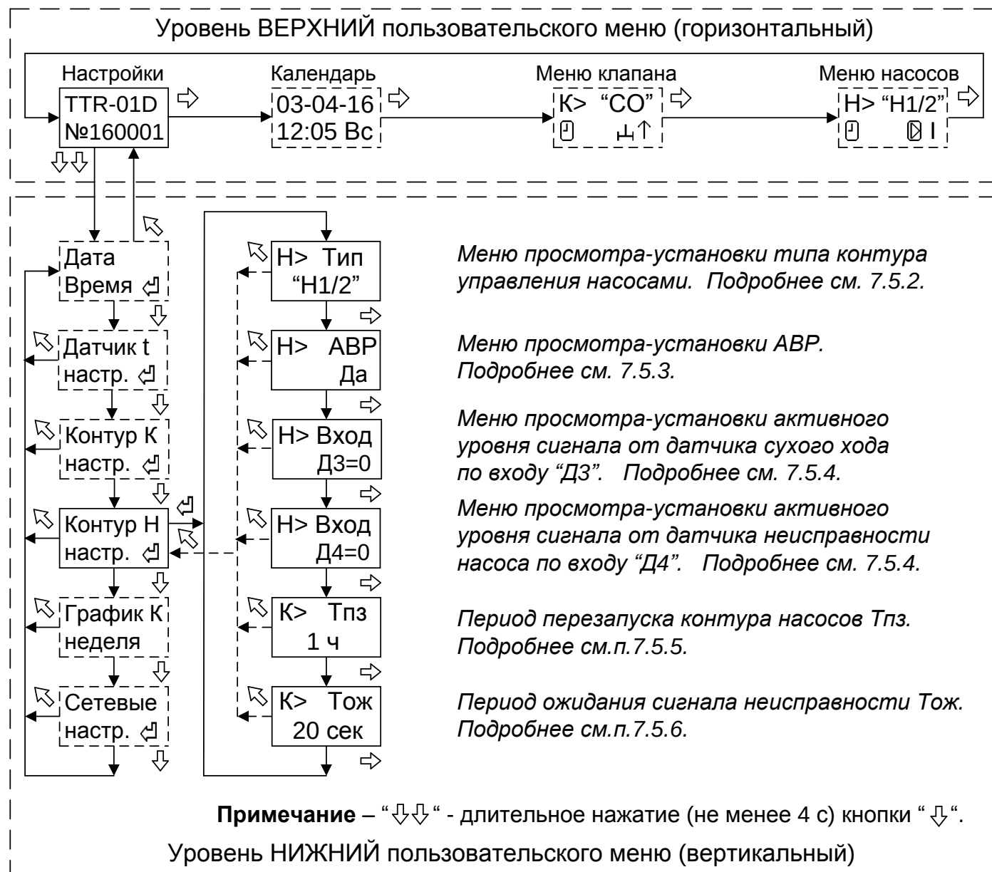
Рисунок 9 – Структура меню настройки параметров контура управления насосами.
