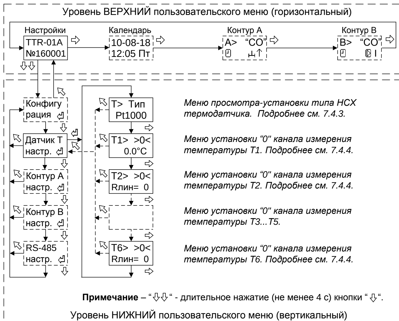
Рисунок 3 - Структура меню настройки канала измерения температуры
