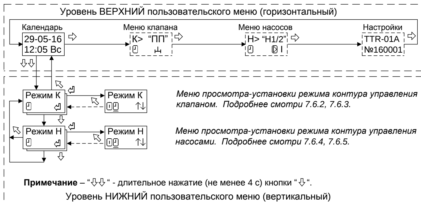
Рисунок 7 - Структура меню настройки режима работы контура
