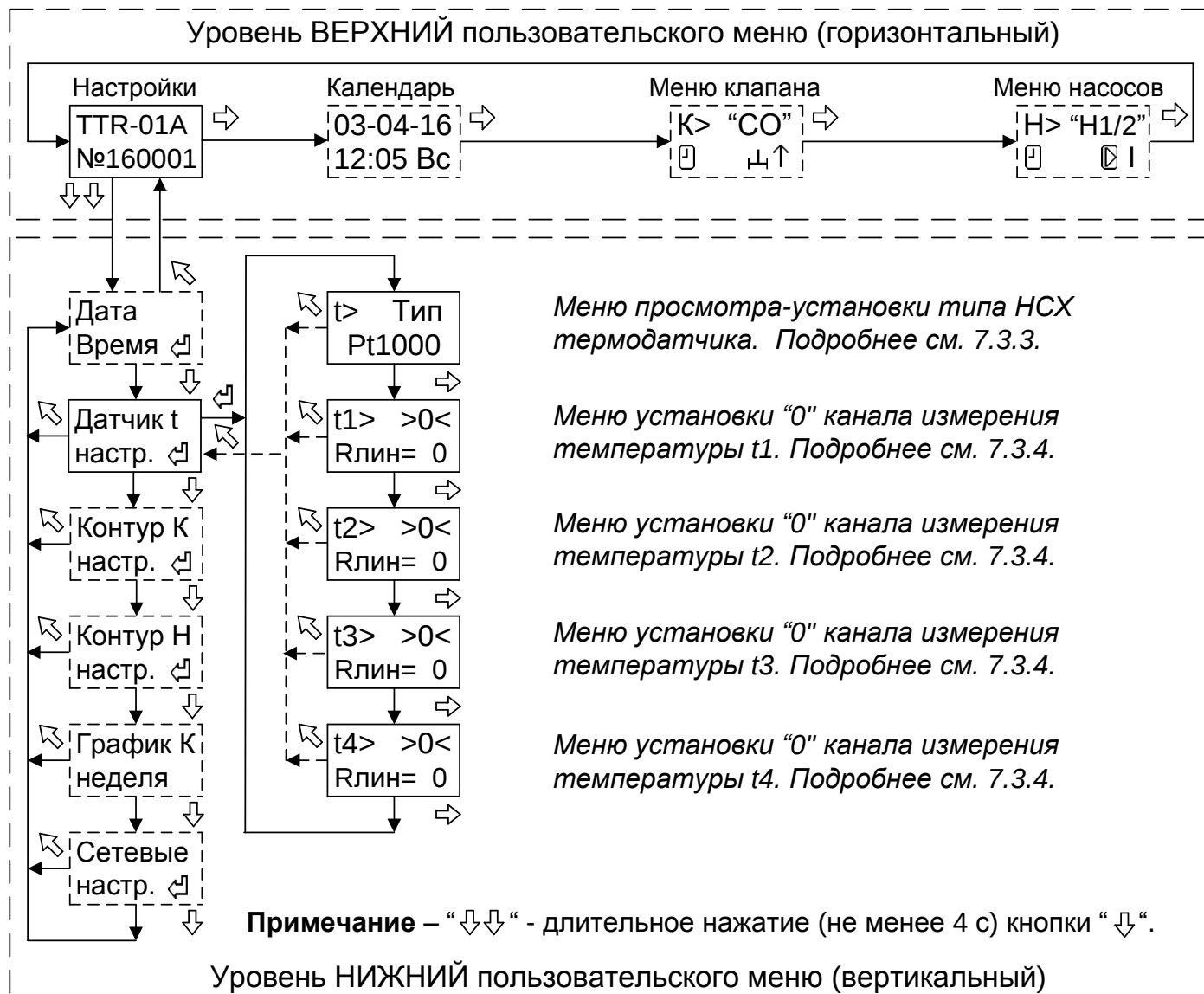
Рисунок 3 - Структура меню настройки канала измерения температуры
