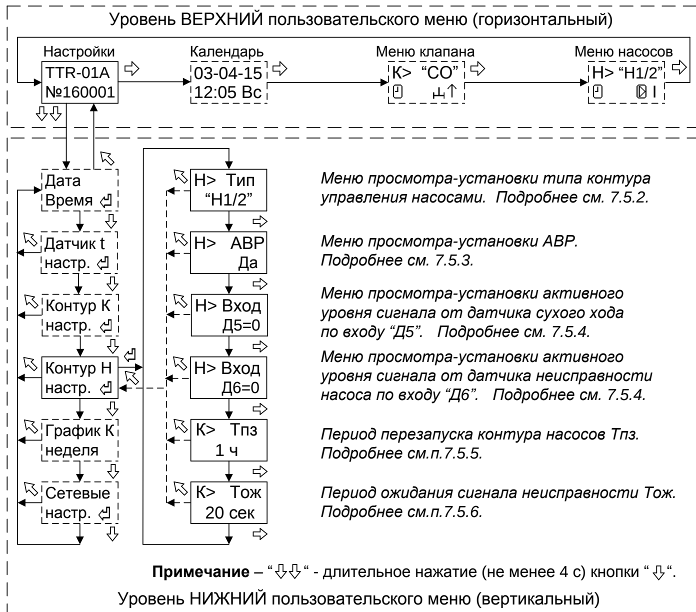
Рисунок 9 - Структура меню настройки параметров контура управления насосами.
