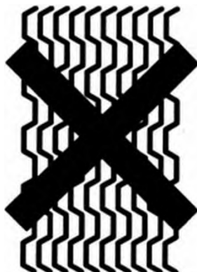
Рисунок В.3 – Вид на пакет пластин при неправильной сборке
