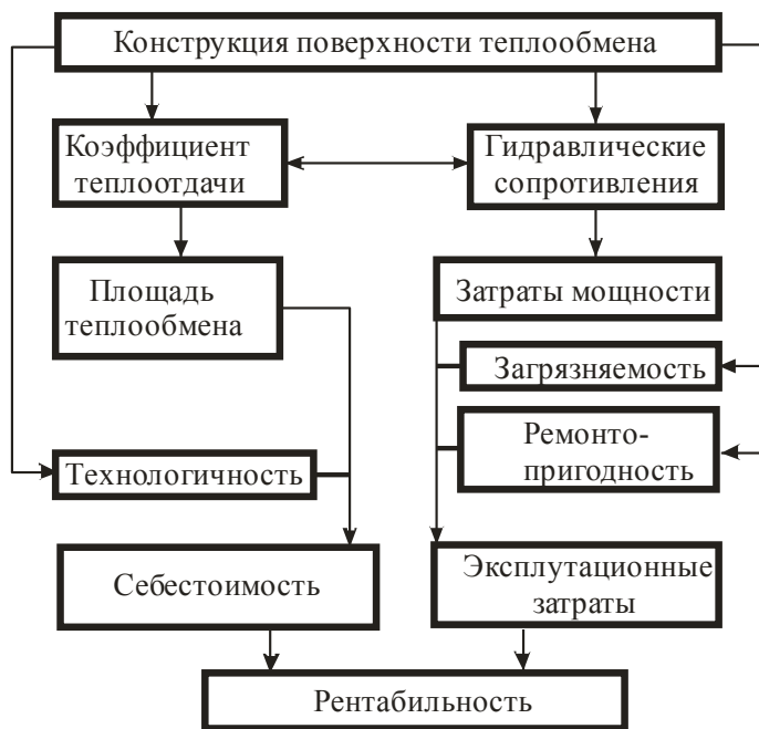
Рис. 1. Взаимосвязь параметров теплообменного аппарата
